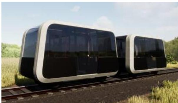
On peut en voir une possible illustration de ce type de train ci-contre, il s'agit de mini-véhicules autonomes équivalents à des véhicules légers.
